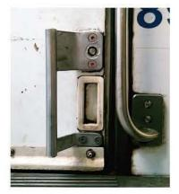
fermeture des portes de loge ne cesse d'évoluer à MTS. Les différents matériels roulants (MF01, MP 89, MF 67, etc) n'ont pas le même système d'ouverture et de fermeture. Il en est de même quant au poids des portes. L'ouverture et la fermeture des porte du MP 89 étant difficile, la direction de la
